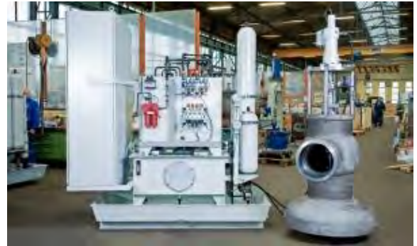
Válvulas de Condicionamiento de Vapor
