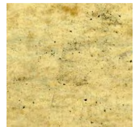
Estilo 300: Fibras Sintéticas depositadas con Aglutinante SBR y Vulcanizado
