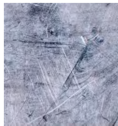
Estilo 500: 98% Grafito Puro con insertos de acero inoxidable 316 de .002" de grosor
