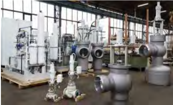
Sistemas de Bypass de Turbinas
