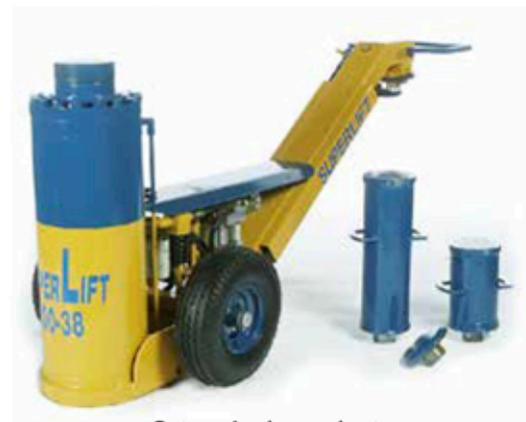
Gatas. Accionamiento neumático/Hidráulico ó electro hidráulico para neumáticos OTR
