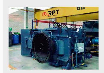
Nuestro protocolo de reparaciones incluye siempre una minuciosa inspección de cada componente crítico del equipo, incluyendo ensayos NDT con tintes penetrantes, partículas magnéticas y/o ultrasonido, para comprobar la integridad de los elementos.
